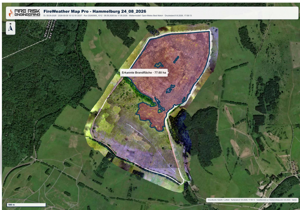
Abbildung 5: Orthofotobasierte Brandflächenerkennung in FireWeather Map Pro. Die Kartenansicht weist eine erkannte Brandfläche von 77,60 ha aus. Gegenüber der unabhängig GIS-gestützt abgegrenzten Brutto-Brandfläche von 78,0443 ha beträgt die Differenz 0,4443 ha (0,57 %). Quelle: Fire Risk Engineering, FireWeather Map Pro, Druckstand 09.09.2026; UAV-Orthofoto nach der Maßnahme.
